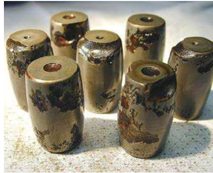
Wälzkörper eines gefälschten Pendelrollenlagers
